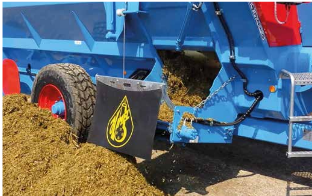
HIMEL HX108 mit Standardaustragung vorne rechts
