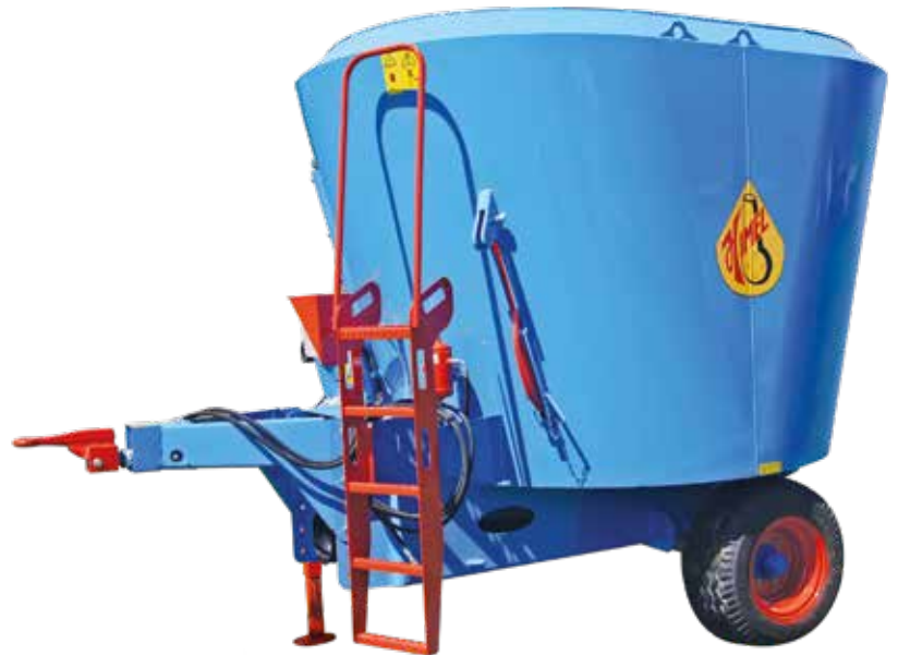
Futtermischwagen V7-18 mit Aufstiegsleiter
