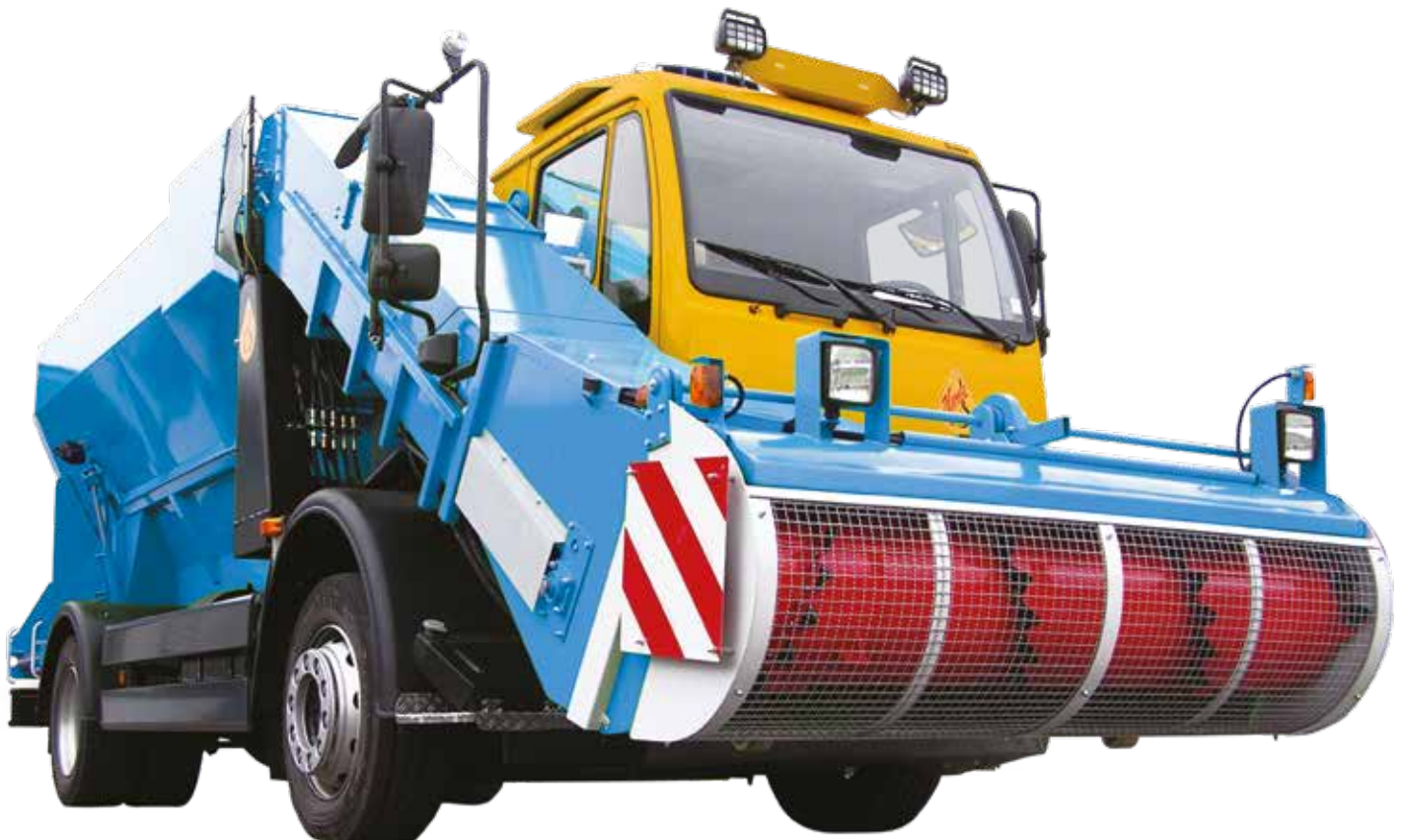
Selbstfahrer SF120 mit Fräse und 3 Schnecken Mischsystem
