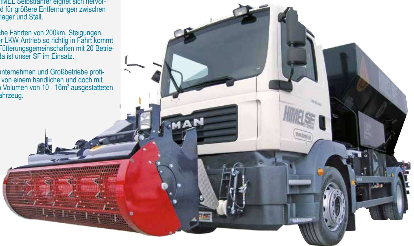
Futtermischwagen SF160 mit Hochleistungsfräse
