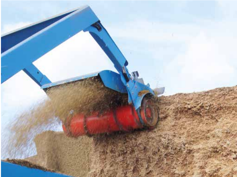
Die freischneidende Hochleistungsfräse mit Absenkautomatik
