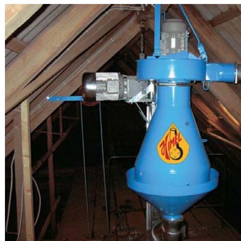
Pré-nettoyeur intégré dans une installation.
