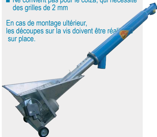
Vis à grains mobile avec nettoyeur à tuyaux
