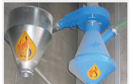
Pré-nettoyeur V25 avec cyclone
