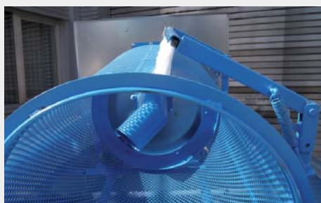
HTR vue intérieure avec un cylindre de criblage
