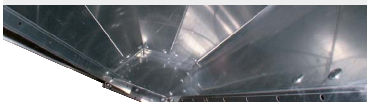
Vue intérieure de la trémie de décharge avec trappe
