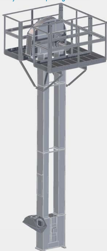
Modélisation CAO 3D de l'élévateur à godets HSK avec plate-forme
