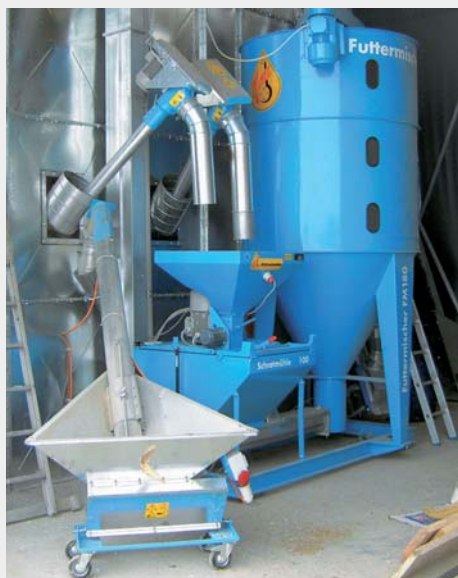
Fabrique d'aliments HIMEL avec mélangeur FMK 180 et concasseur SC
