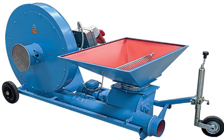
Suceuse à grains KM-Z avec trémie
