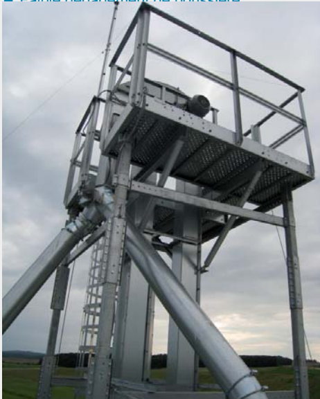
Élévateur à godets avec plate-forme de travail
