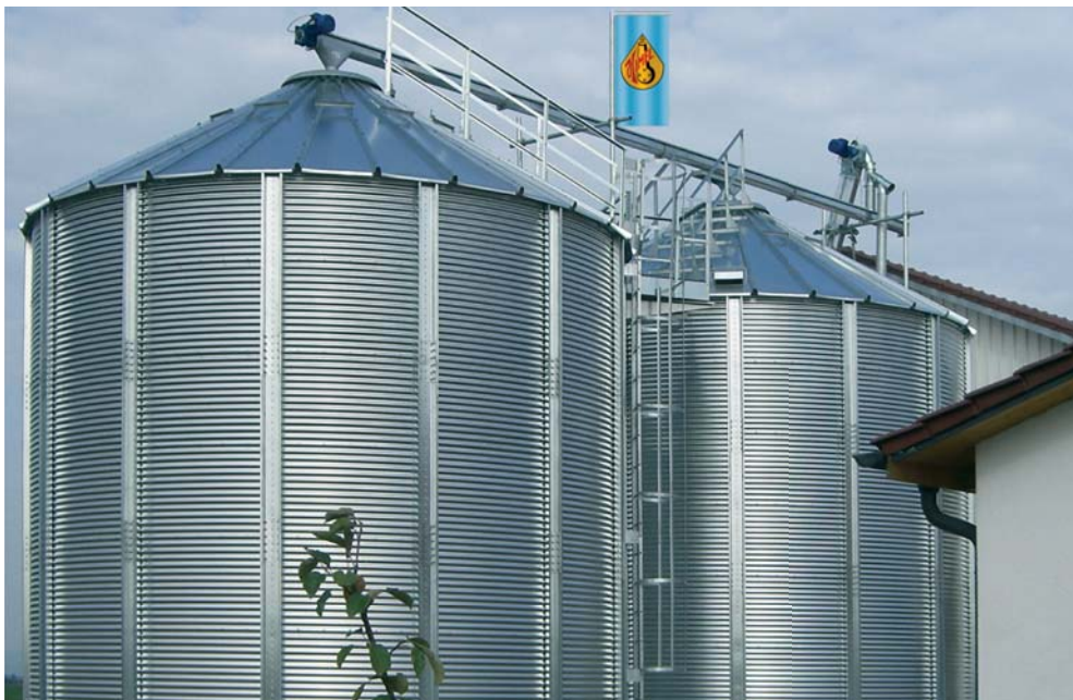
Silos extérieurs HIMEL avec élévateur à chaîne et convoyeur à vis
