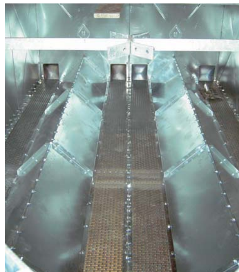
Silo du stockage rectangulaire avec tamis d'aération au sol et vidange pneumatique
