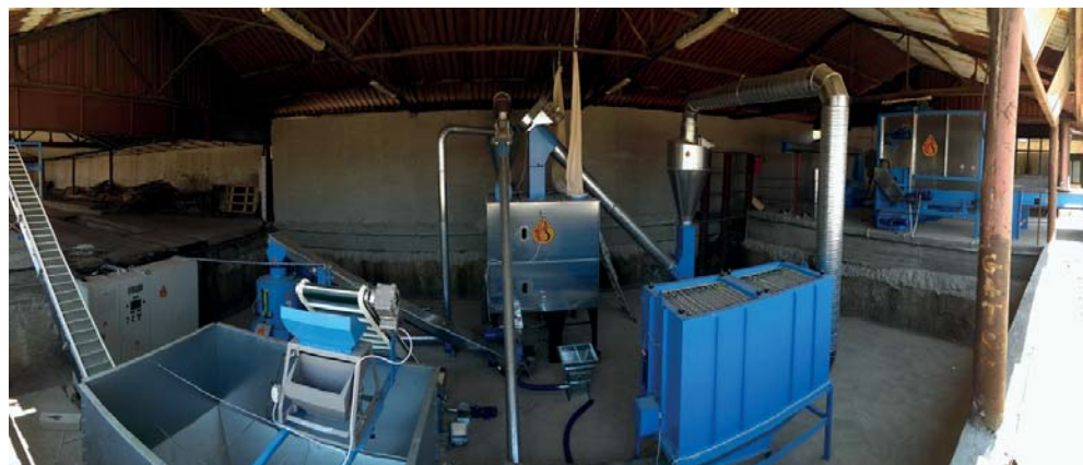
Usine de production de granulés en Roumanie avec un silo d'aération au premier plan
