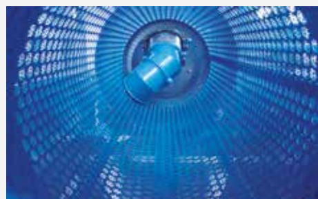
HTR mit 2 Siebtrommeln, Innenansicht
