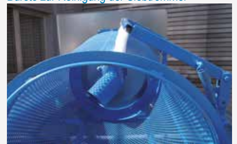
HTR Innenansicht mit einer Siebtrommel
