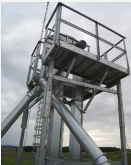
Becherelevator mit Bedienpodest
