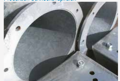
Schneckenflansch und Bauteile Förderschnecken Ø300
