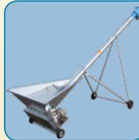
sind mit einem großen Trichter und Mengenregulierung ausgestattet. Sie lassen sich durch ein Fahrwerk mobil einsetzen. Die starken Antriebsstationen sind serienmäßig angebaut.
