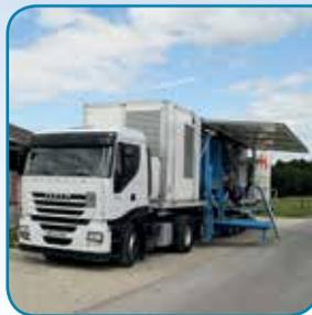
Мобильная установка гранулирования может перерабатывать практически все неиспользованные сельскохозяйственные побочные продукты в гранулы. Вся система очень компактна и интегрирована в полуприцеп грузового автомобиля.
